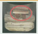
**Breite Feuerräume mit** wenig Tiefe befüllen Sie mit der Längsseite nach vorne.
